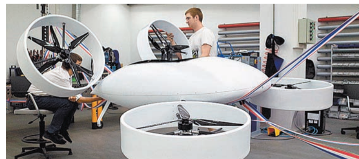
Аэротакси — транспортный аппарат будущего — позволит облетать все городские пробки. Его прототип создан специалистами центра «Кинетика» НИТУ «МИСиС». Летать такси будет со скоростью 300 км/ч и управляться в беспилотном режиме. Фото misis.ru
