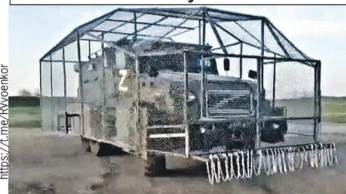
**Купол-сетка не закрывает обзор, а цепи снизу - чтобы дрон не прошмыгнул под колеса.**
