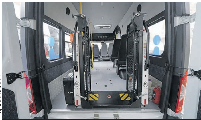
Специальный механизм позволяет поднять пассажира вместе с инвалидным креслом в салон.
