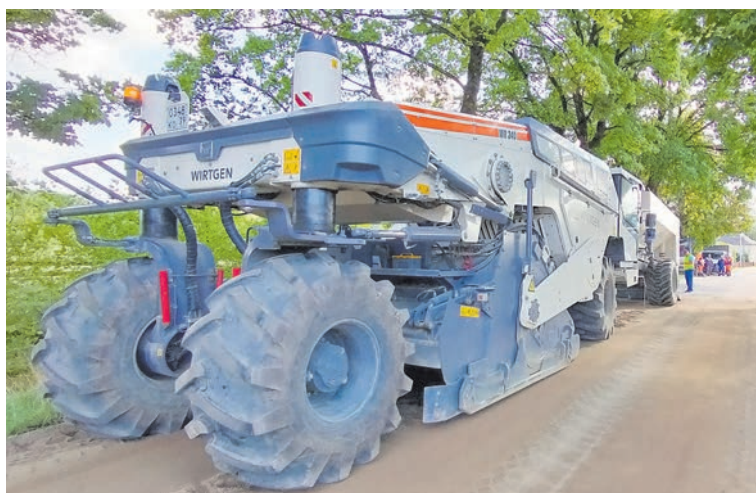
Ресайклер - огромная машина с гигантскими колесами - буквально перемалывает старое покрытие, выдавая стабилизированный грунт.
