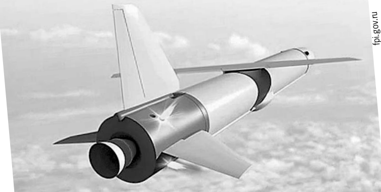
Многоразовая ракета «Крыло-СВ», по плану, должна приземляться не вертикально, а как самолет.
