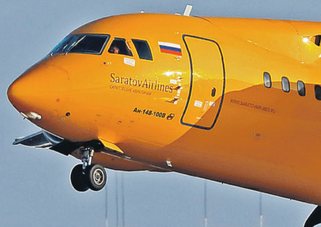
Так выглядит датчик скорости на носу лайнера, который мог отказать из-за обледенения.
