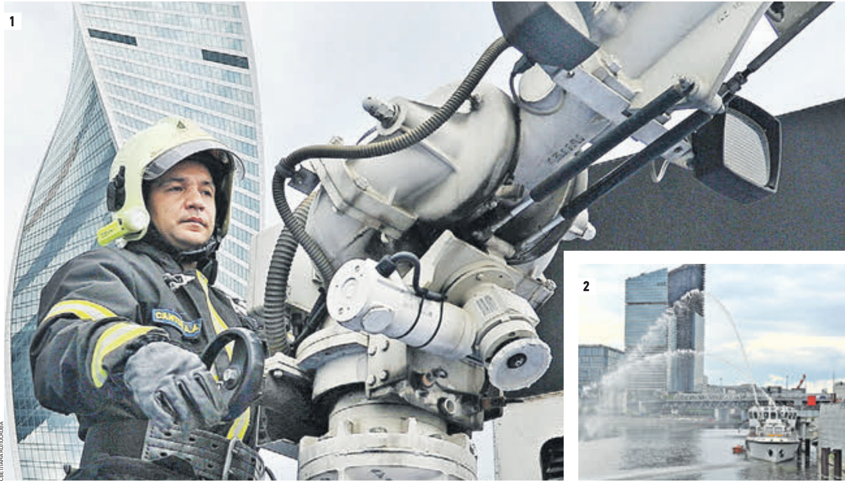
Вчера 15:23 Пожарный отряда по тушению пожаров на водных объектах Альберт Сайтов за одним из лафетов системы водораспыления и водяных завес корабля «Полковник Чернышев» (1) Водяные струи из стволов корабельных стационарных установок пожаротушения достигают 120 метров (2)
