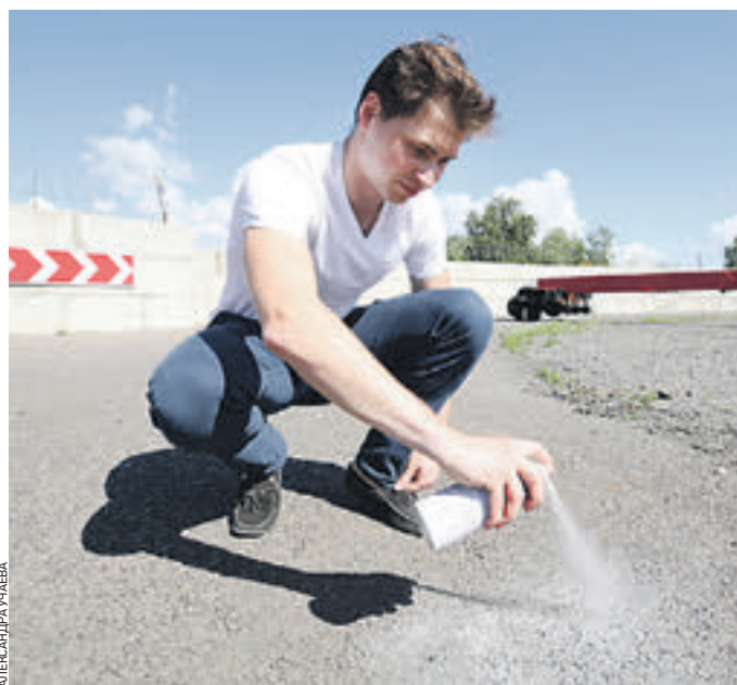
Вчера 15:02 Аспирант МАДИ Глеб Понарин наносит на асфальт 3D-краску, благодаря которой асфальтобетонное покрытие можно увидеть на компьютере с помощью специального программного обеспечения
