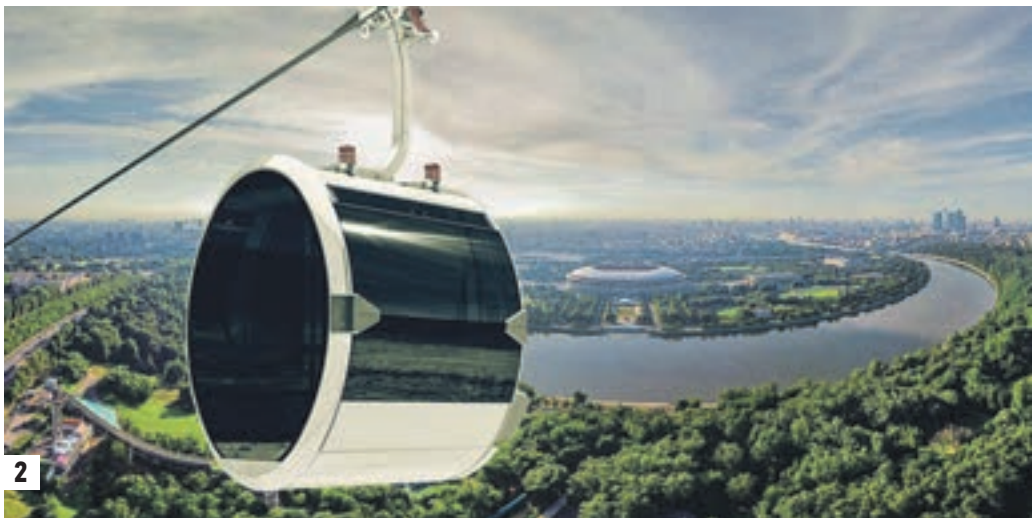
1 Проект верхней станции канатной дороги. Она расположится на улице Косыгина. Всего будет три станции: среднюю построят на Воробьевской набережной, а нижнюю — на Лужнецкой (1) Кабины канатной дороги будут вмещать по восемь человек. В летнее время их оборудуют зацепами для перевозки велосипедов (2)
