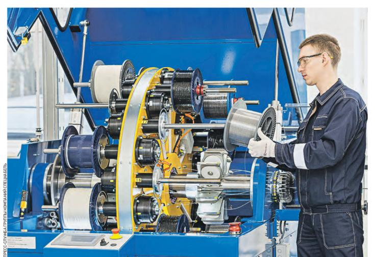
Вчера 12:07 Инженер-технолог Московского кабельного завода Александр Диковинный устанавливает катушку на аппарат для производства кабеля
