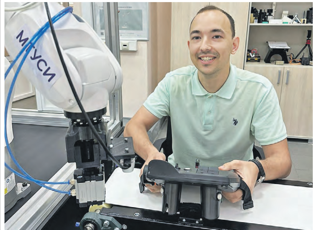
11 сентября. Разработчик идеи захвата, заместитель заведующего кафедрой Никита Белов управляет манипулятором, к которому прикреплен пневматический магнитный захват
