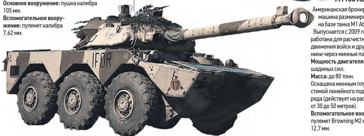
Колесный танк AMX-10RC Французская боевая бронированная машина, серийно выпускалась в 1976–1994 гг. Мощность двигателя: 300 л. с. Скорость (по шоссе): 85 км/ч. Запас хода (по шоссе): 1000 километров. Основное вооружение: пушка калибра 105 мм. Вспомогательное вооружение: пулемет калибра 7,62 мм.
