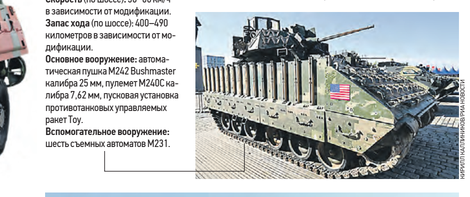
БМП M2A2 Bradley ODS-SA «М2 Брэдли» — боевая машина американской пехоты. Производится с 1979 года. Мощность двигателя: 500 лошадиных сил. Скорость (по шоссе): 56–66 км/ч в зависимости от модификации. Запас хода (по шоссе): 400–490 километров в зависимости от модификации. Основное вооружение: автоматическая пушка M242 Bushmaster калибра 25 мм, пулемет M240С калибра 7,62 мм, пусковая установка противотанковых управляемых ракет Топу. Вспомогательное вооружение: шесть съемных автоматов M231.
