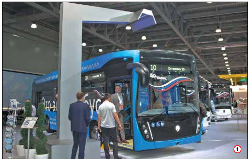
1. КАМАЗ-6282 в версии для «Мосгортранса» в комплекте с элементами зарядной инфраструктуры.
