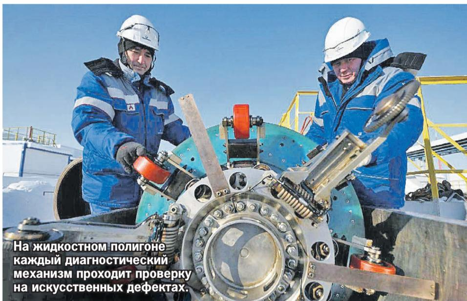
На жидкостном полигоне каждый диагностический механизм проходит проверку на искусственных дефектах.
