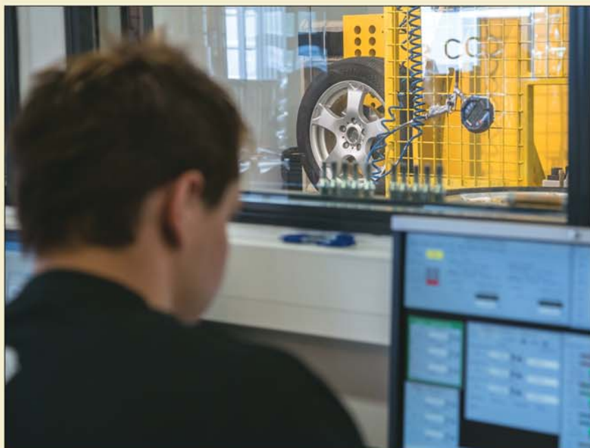
Отдельный аппарат тестирует поведение шины при имитации радиальных и диагональных перегрузок.
