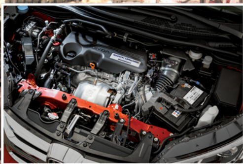
Наиболее важным техническим новшеством CR-V 2015 модельного года можно считать появление в моторной гамме 1,6-литрового турбодизельного двигателя i-DTEC, выдающего 160 л. с. мощности и 350 Нм крутящего момента.
