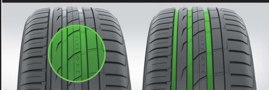
Шина получила фирменный индикатор износа протектора (DSI), размещенный на центральном ребре.
