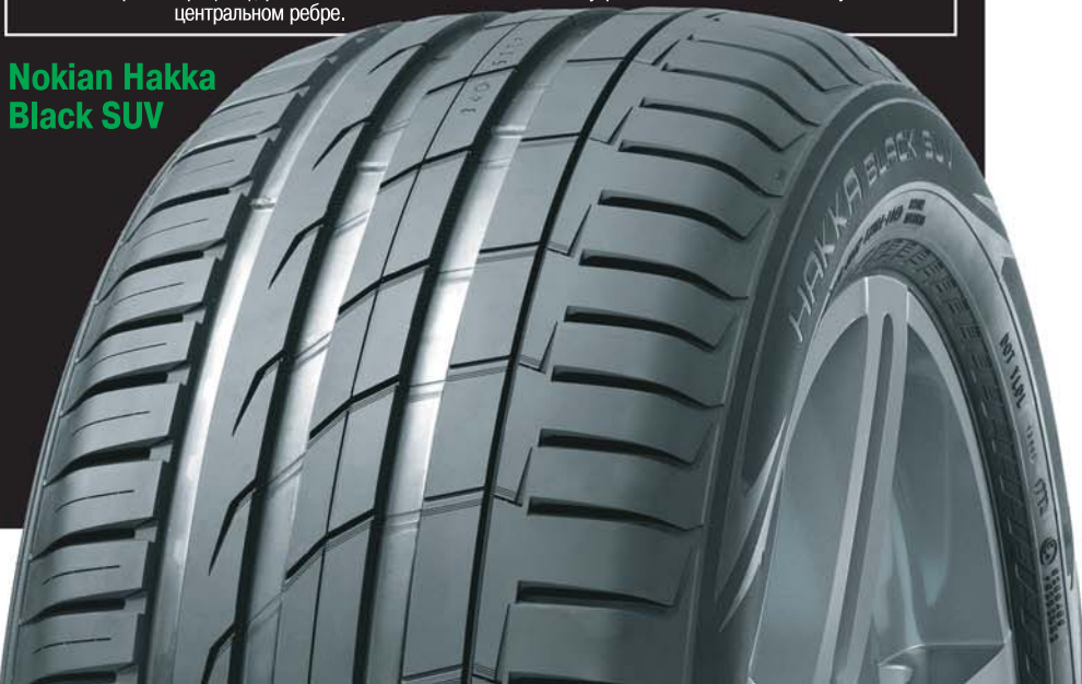
Канавки прорезаны по центральным ребрам от внутреннего «плеча» к внешнему.
