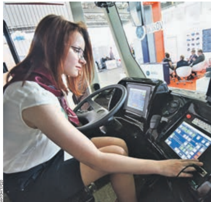
Вчера 12:50 Сотрудник компании-разработчика Татьяна Иванова тестирует систему, возвращающую штангу троллейбуса на провода
